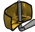
Messung der Wandstärke
